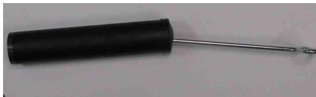
Rysunek 9-3 : Tuba smarownicy, głowica zdjęta, tłoczysko nurnika wysunięte i zablokowane
