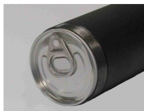
Rysunek 9-4 : Tuba ze smarem włożona do metalowej tuby smarownicy
