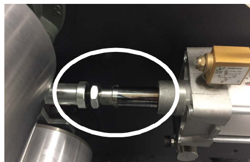
Rysunek 5-1 Przykład: tłoczysko rolki tańczącej z zaznaczonymi zanieczyszczeniami (PO LEWEJ) oraz luźne tłoczysko (PO PRAWIEJ)
