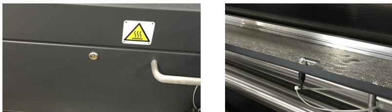
Rysunek 4-3 Zamknięte przednie drzwiczki rewizyjne i kluczyk (po lewej) oraz otwarte drzwiczki i widoczna płyta grzejąca (po prawej)
