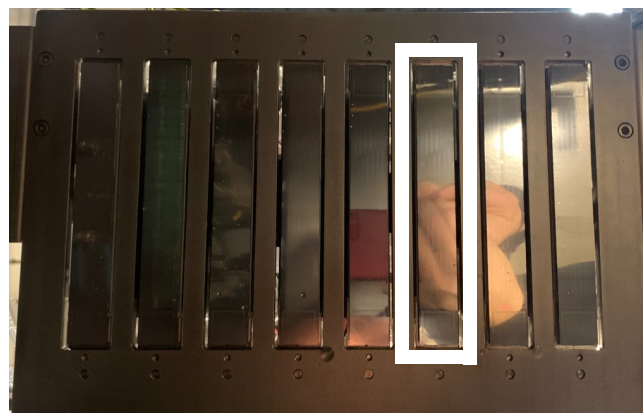
Rysunek 3-10 Płytkę głowic drukujących z zaznaczonym obszarem głowicy drukującej (część czołowa)
