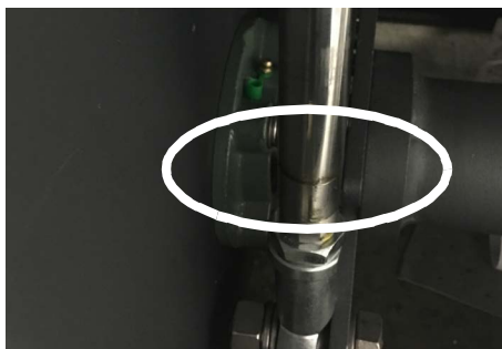
Rysunek 5-1 Przykład: tłoczysko rolki tańczącej z zaznaczonymi zanieczyszczeniami (PO LEWEJ) oraz luźne tłoczysko (PO PRAWIEJ)
