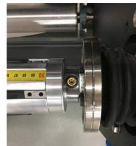
Rysunek 5-5 Zablokuj uchwyty bezpieczeństwa rdzenia odwijarki
