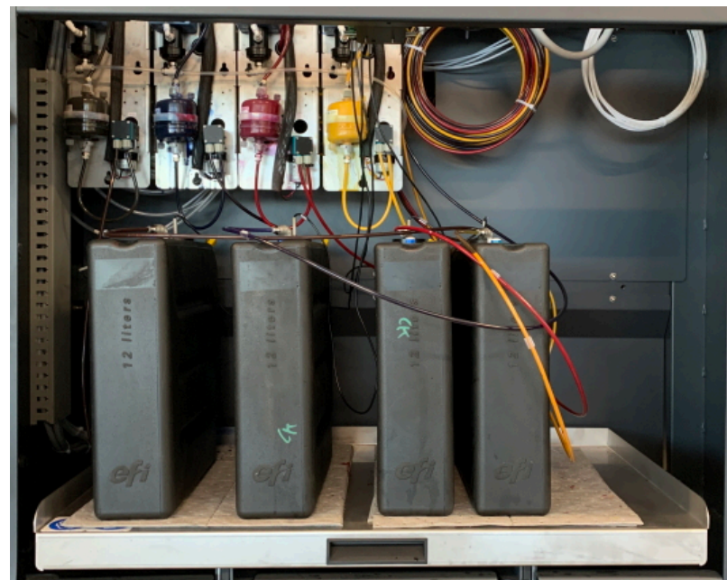
Rysunek 5-1 Komora na tusz ze stacjonarnymi zbiornikami z tuszem do wielokrotnego napełniania
