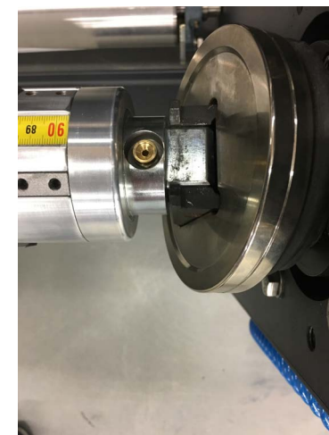
Rysunek 5-4 Odblokuj uchwyty bezpieczeństwa rdzenia odwijarki
