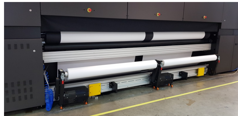
Rysunek 8-16 : Wał powietrzny napędzanej silnikiem odwijarki
