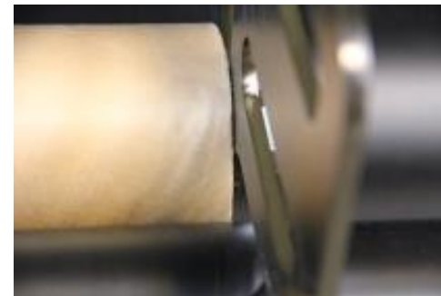
Rysunek 6-53 : Podłącz ograniczniki do gilzy nośnika, pozostawiając 2 mm odstępu
