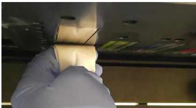
Rysunek 5-5 Przetrzyj dysze głowic
