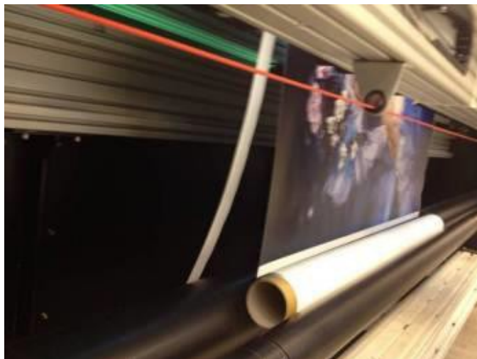
Rysunek 8-10 : Odpady z nośników wypadają z drukarki
