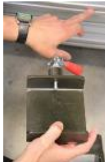
Rysunek 6-53 : Podłącz ograniczniki do gilzy nośnika, pozostawiając 2 mm odstępu
