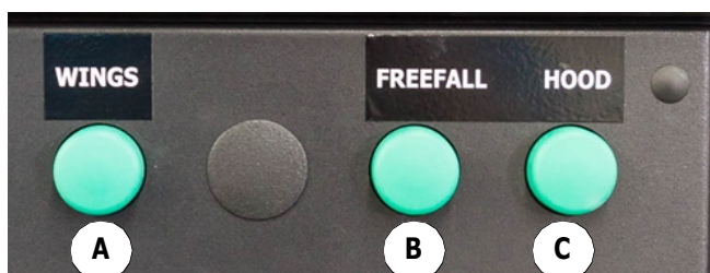
Rysunek 3-3 : Przyciski otwierania pokrywy i sterowania z lewej strony
