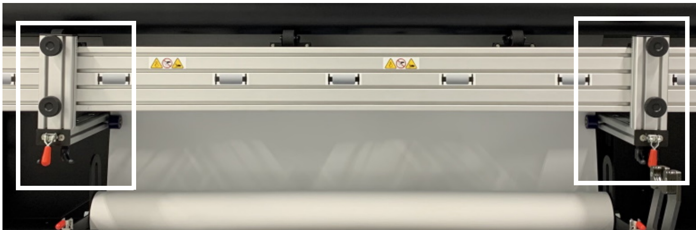
Rysunek 6-38 Moduły prostowania nośnika z kołami po obu stronach nośnika
