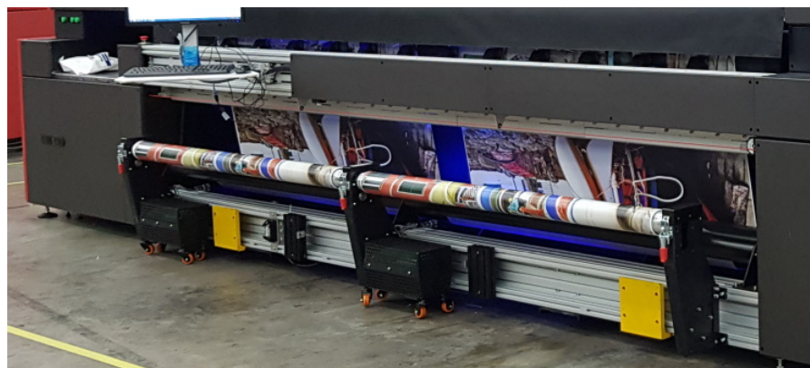
Rysunek 8-15 : Wał powietrzny napędzanej silnikiem nawijarki
