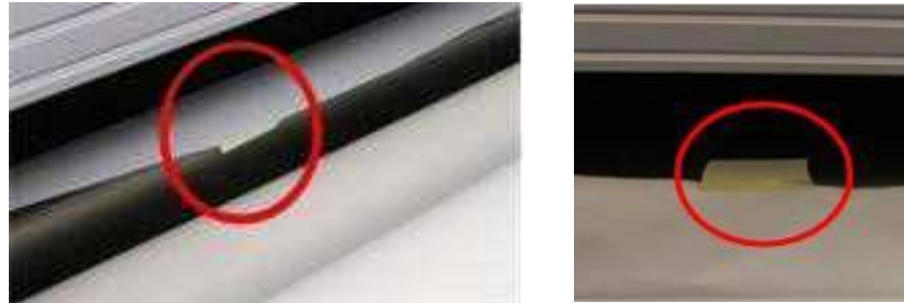
Rysunek 6-28 : Nośnik przyklejony do rolki (F), umożliwiając drukowanie stroną do góry lub do dołu.
