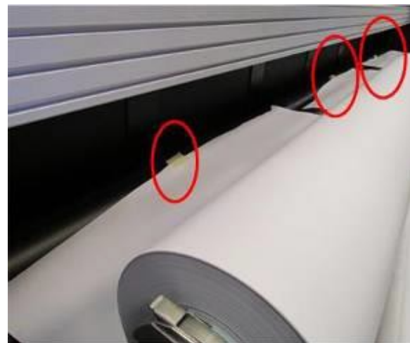
Rysunek 6-28 : Nośnik przyklejony do rolki (F), umożliwiając drukowanie stroną do góry lub do dołu.
