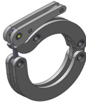
Rysunek 6-30 : Mocowanie gilzy – pozycja zablokowana
