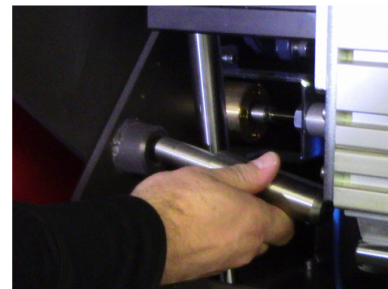
Rysunek 2-1 Zainstaluj kołek osadzający
