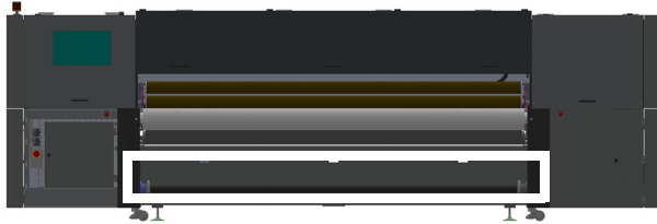
Rysunek 3-22 Wał powietrzny – lokalizacja z tyłu
