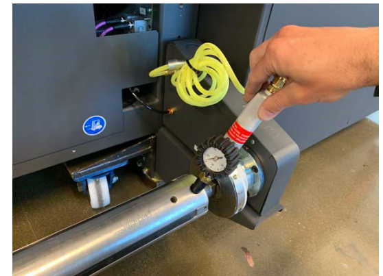
Rysunek 6-11 Napełnij rdzeń nośnika
