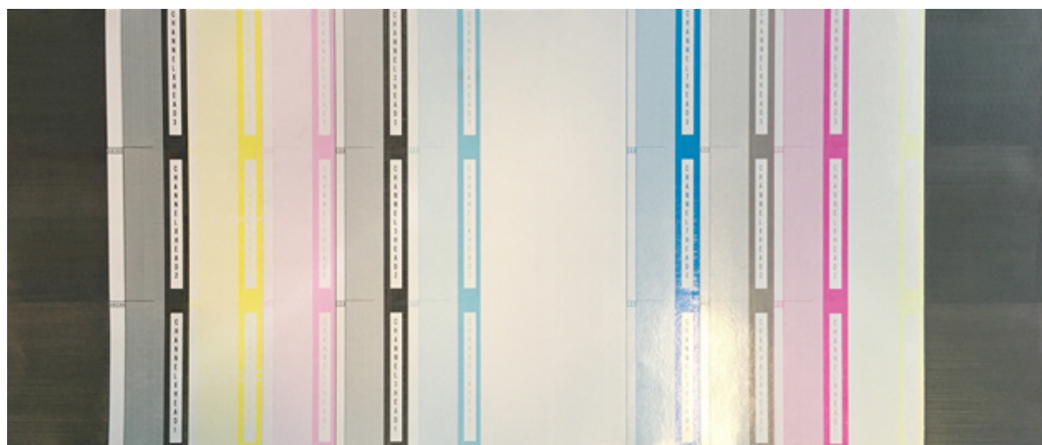
Rysunek 7-5 Test sprawdzania dysz
