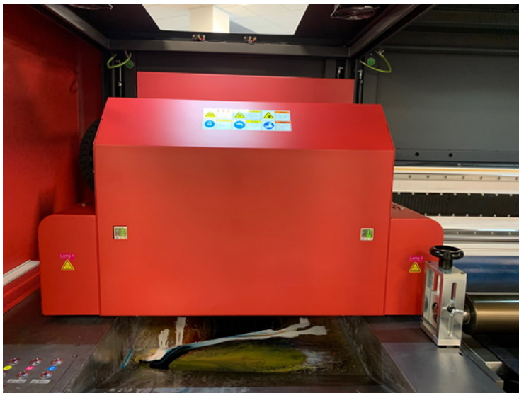
Rysunek 3-5 Karetka drukująca — zainstalowano pokrywę
