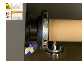
Rysunek 6-9 Zablokuj rdzeń nośnika
