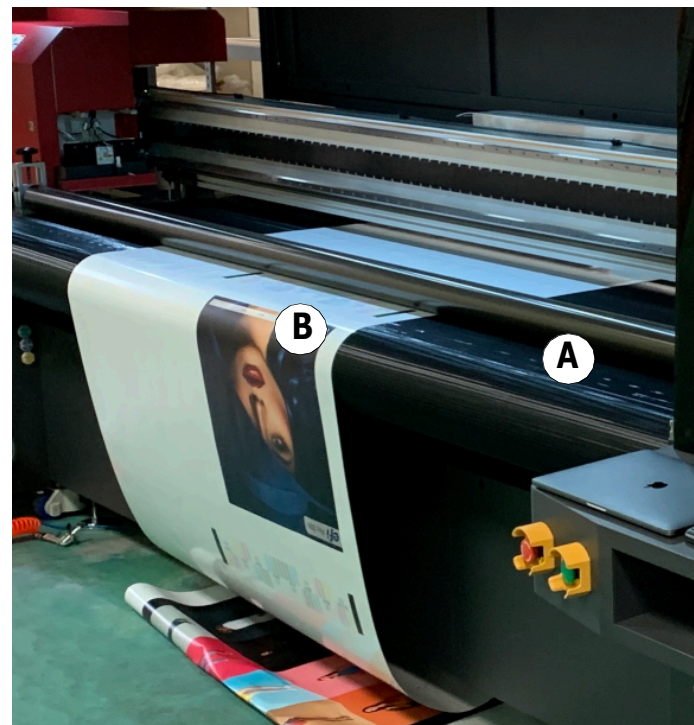
Rysunek 3-12 Taśma podciśnieniowa nośnika podczas drukowania
