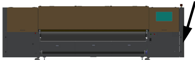
Rysunek 3-31 Lokalizacja komory z układami elektronicznymi
