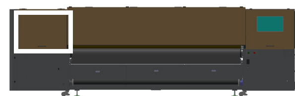
Rysunek 2-4 Pozycja wyjściowa karetki drukującej
