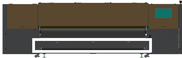
Rysunek 3-20 Wał powietrzny – lokalizacja z przodu
