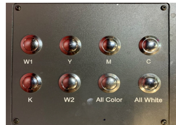
Rysunek 7-1 Panel sterowania oczyszczaniem
