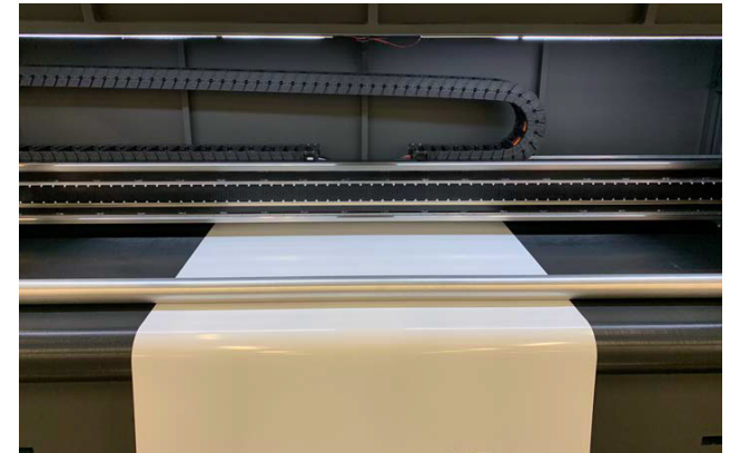
Rysunek 6-10 Nośniki na rolce – wyśrodkowane i wyprostowane
