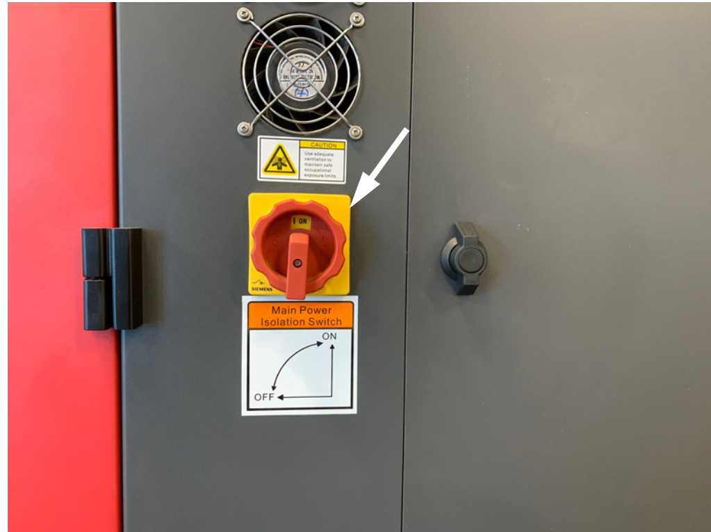
Rysunek 3-34 Wyłącznik główny prądu przemiennego
