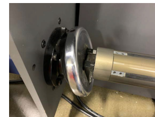
Rysunek 6-8 Odblokuj rdzeń nośnika
