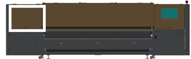
Rysunek 3-3 Pozycja wyjściowa karetki drukującej
