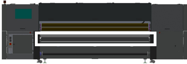
Rysunek 3-19 Rolka prowadnicy nośnika – lokalizacja z tyłu
