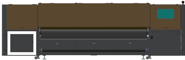
Rysunek 3-29 Lokalizacja komory na odpady
