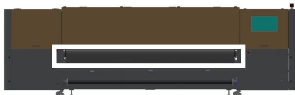
Rysunek 3-11 Lokalizacja taśmy podciśnieniowej nośnika
