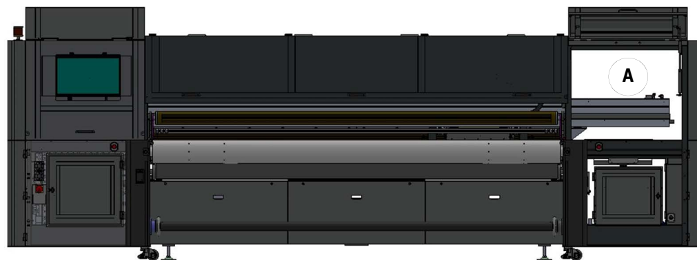
Rysunek 4-2 Dostęp do tylnej komory położenia początkowego karetki
