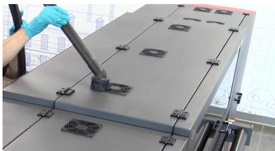
Rysunek 6-1 Wyczyścić wentylatory za pomocą odkurzacza przemysłowego
