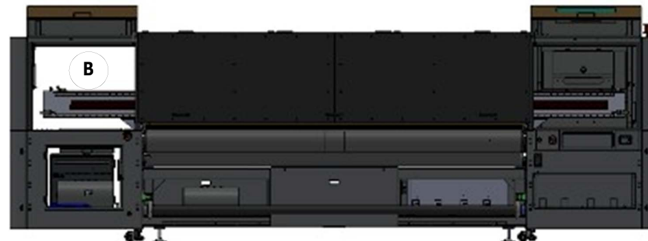
Rysunek 3-12 Komora położenia początkowego karetki
