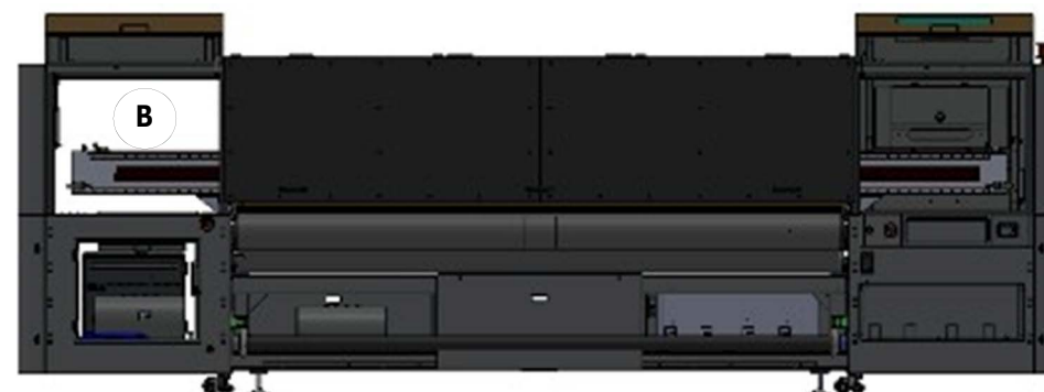
Rysunek 3-28 Komora położenia początkowego karetki
