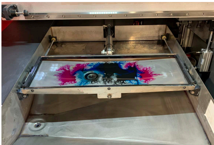
Rysunek 3-30 Taca na mikrodyasz przed czyszczeniem
