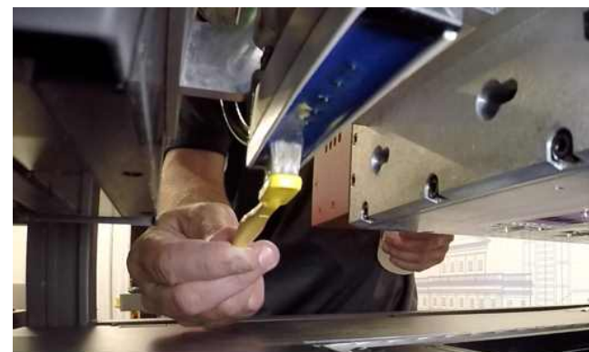
Rysunek 4-18 Czyszczenie prętów antystatycznych
