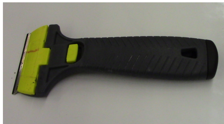
Rysunek 4-12 Usuwanie zabrudzeń z powierzchni soczewki LED (po lewej) i skrobak (po prawej)
