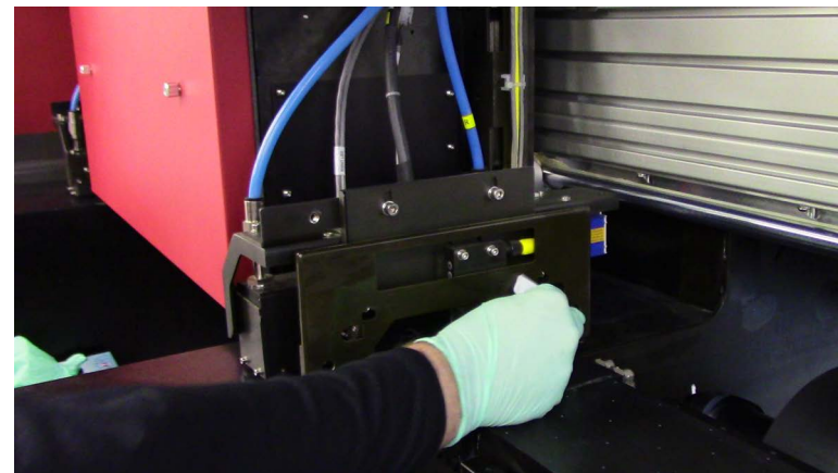
Rysunek 4-14 Wycieranie PRAWYCH czujników przeciwkolizyjnych karetki
