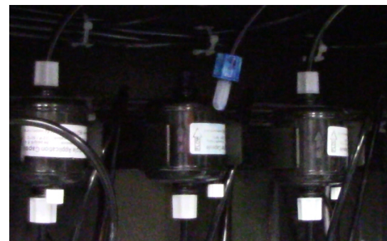
Rysunek 9-3 Plastikowa nasadka (po lewej) i plastikowa nasadka na linii tuszu (po prawej)
