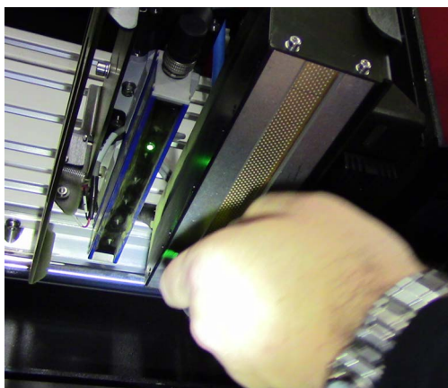
Rysunek 4-12 Usuwanie zabrudzeń z powierzchni soczewki LED (po lewej) i skrobak (po prawej)
