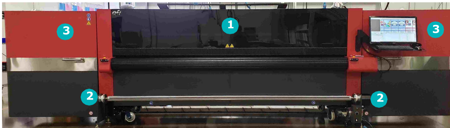
Rysunek 2-3: Niebezpieczeństwo szczątkowe związane z zaplątaniem się i ryzykiem zmiążdżenia z przodu urządzenia
