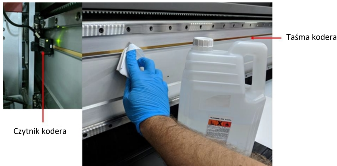
Rysunek 7-2 Wycieranie taśmy kodera liniowego
