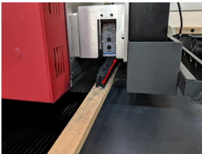
Rysunek 5-11 Pręty jonizatora
