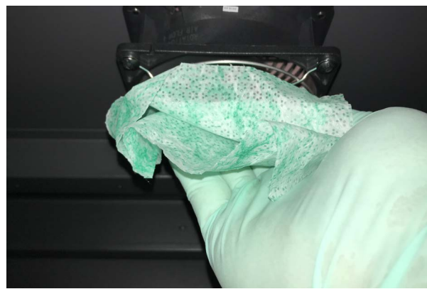
Rysunek 7-3 Wyczyścić wentylatory wyciągowe
