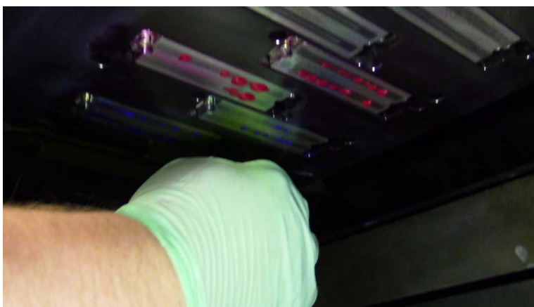
Rysunek 5-12 Trzymanie ściereczki do powierzchni głowicy drukującej
