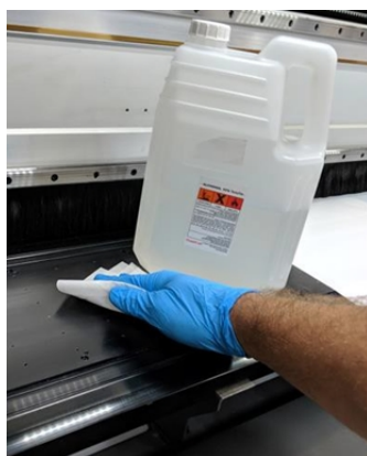
Rysunek 5-2 Wycieranie stołu do drukowania
