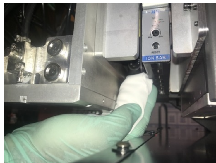
Rysunek 6-6 Czujnik wysokości karetki – prawa strona karetki, po lewej stronie od jonizatora
