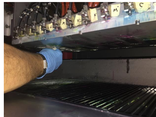
Rysunek 5-13: Przetrzyj dysze głowic
