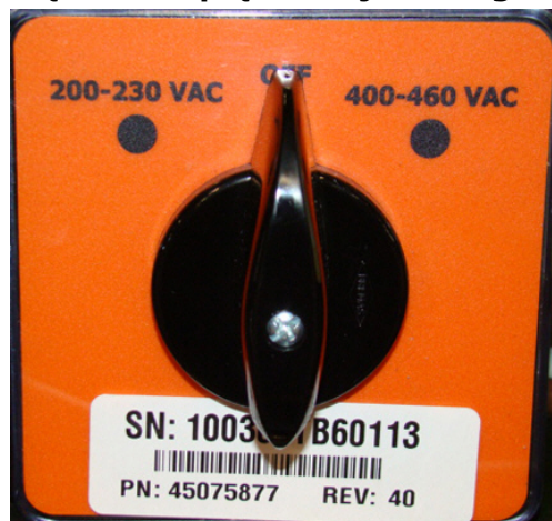
Rysunek 1-3: Główny przełącznik napięcia wejściowego AC (prądu przemiennego)
